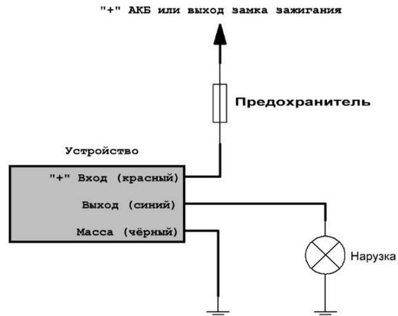
Рис2. Схема подключения.
