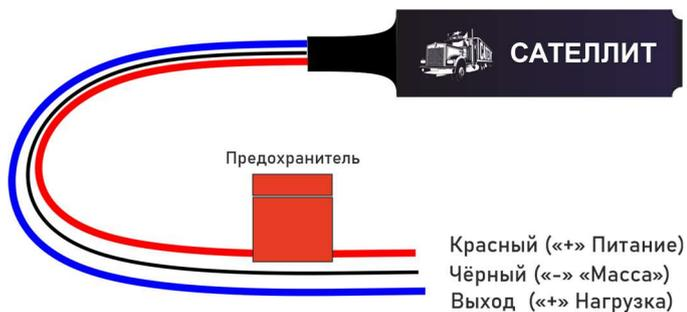
Рис1. Вид устройства и назначение выводов
